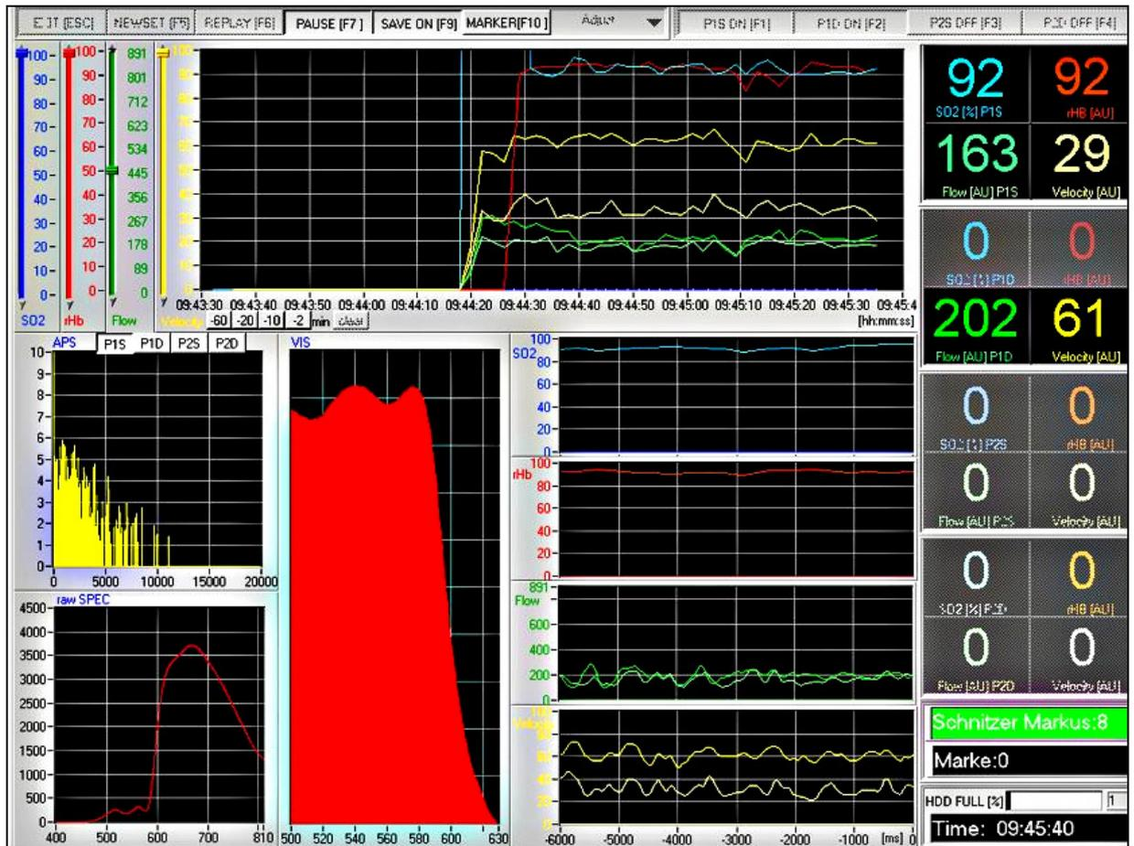
Abbildung 12: Bildschirm des Laserdopplers während einer Messung
