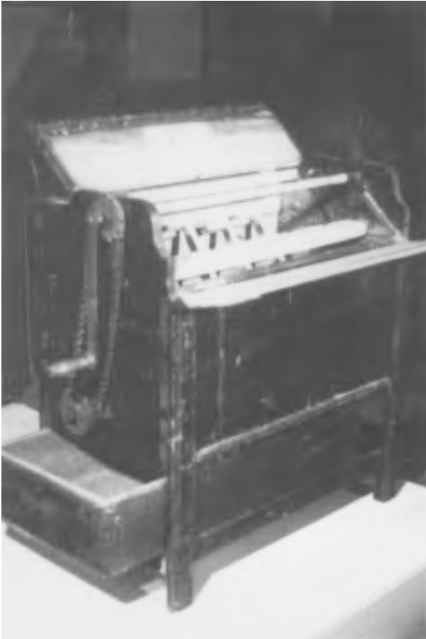
Sackausklopfmaschine: Aus Mehlsäcken wird auch das letzte Stäubchen herausgeklopft. Erfindung eines schwäbischen Tüftlers zu Beginn dieses Jahrhunderts.
