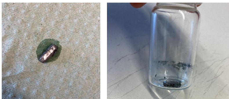
Abbildung 6: Verzinkter Rührfisch nach Umsetzung von 2 mit einem Äquivalent \text{ZnBr}_2 .
