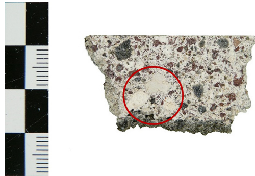
Abb. 134. Linosa, Monte Bandiera. Gebrannte (?) Kalksteine aus dem Fundspektrum der UT 9 im Erosionsgebiet unterhalb der Zisternen Z9–Z13 (links); Verputzprobe mit Fragmenten ungebrannten Kalksteins und Zuschlägen aus Vulkangestein in Kalkbindemittel (LIN_MBAN_Z3_W2) (rechts).
