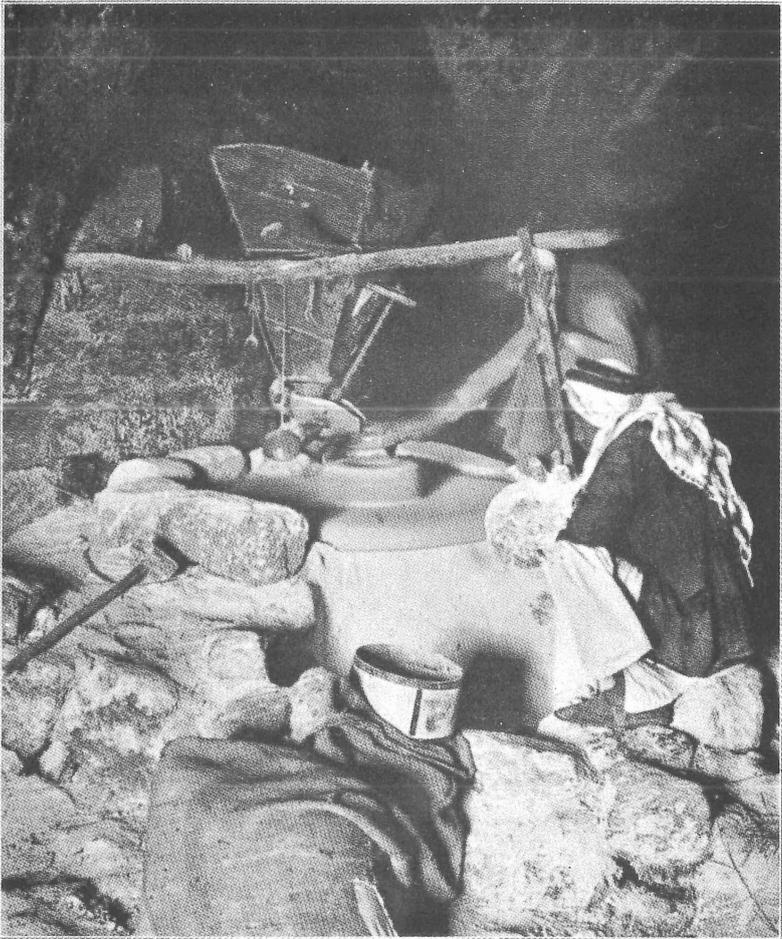
60. Inneres der Wassermühle bei *el-leğgün*. In der Mitte Läufer mit Auge, darüber Mühltrichter mit daruntergebundenem Schuh zum Auslaufen der Körner, S. 247, der Schüttler ist neben dem Trichter aufgerichtet, die Mühlspille, S. 252, liegt links, vorn das Mehlbecken der Mühle, ein Maß und Säcke für Getreide oder Mehl.
