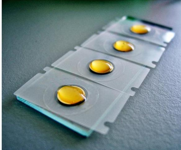
*Abbildung 30: Externe Vorinkubation der Quarzoberfläche mit 70µl 1:10 verdünntem Spenderplasma für 10 Minuten bei Raumtemperatur.*
